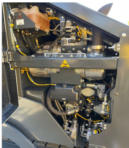
Possibilità di risparmiare fino al 17 % di carburante – impianto idraulico orientato al fabbisogno – con BOMAG ECOMODE.
