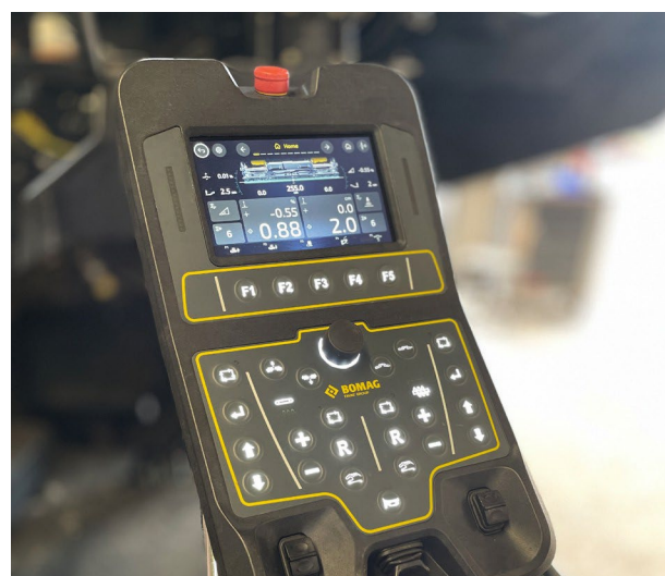
Pannello a lato del banco con ampio display completamente grafico – accesso diretto a tutte le funzioni più importanti
